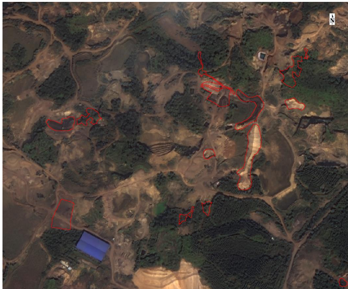
广西贵港某矿区2020年10月28日遥感影像图及变化检测结果
