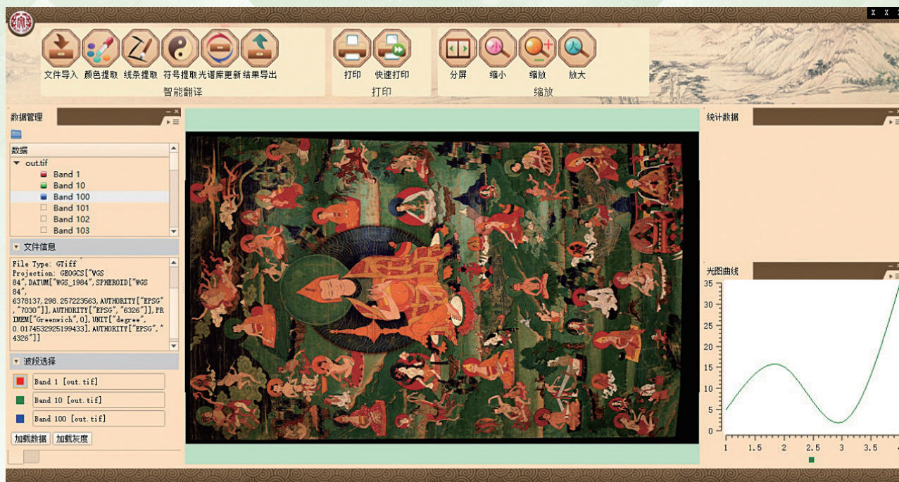
图 2. 文物高光谱扫描仪图像分析软件系统界面图
